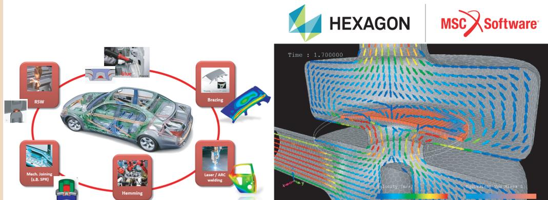
Simufact での接合シミュレーション Marc-scFLOW による流体-構造連成解析
