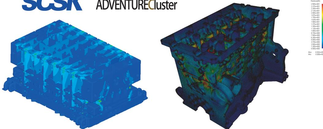
ADVENTUREClusterによる熱応力解析事例。複雑形状かつ部品点数の多いエンジンや金型などの接触計算を、安定かつ短時間で計算することが可能です。製品設計、生産技術、研究開発など様々な分野で開発リードタイム短縮に貢献しています。
